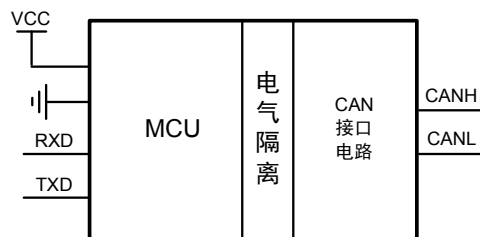
图 1 CSM100 系列模块的功能框图
