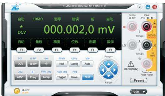
图4.11 DMM6000型数字多用表 PC软件界面
