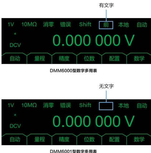
图3.9 DMM6000型与DMM6001型测量信息界面的比较
