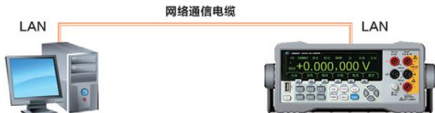
图6.3 LAN接口硬件连接图
