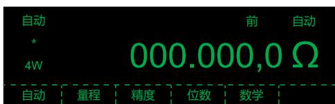
图5.36 四线制电阻测量数据显示界面
