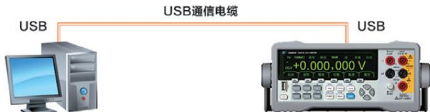
图6.2 USB接口硬件连接图
