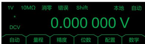
图3.8 DMM6001型数字多用表测量信息界面
