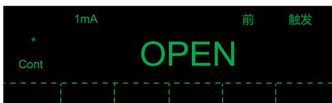
图5.48 连续性测量数据显示界面
