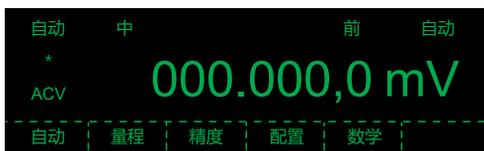
图5.24 交流电压测量数据显示界面
