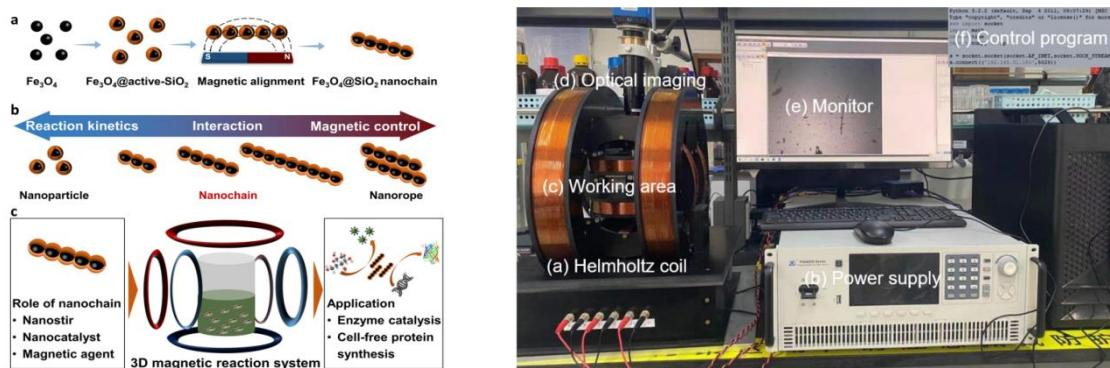
其采用 Python 程序通讯的控制方案，通过三相独立设定及输出控制三维立体线圈，循环下发电压及相位设定数据以产生高频磁场变化从而控制微纳机器人定向运动；通过单相高频高压（600V/3000Hz）、超低频（2Hz）、三相不平衡设定等方式测试磁场不平衡态下的粒子运动。ZLG 研发团队持续提供测试解决方案，不断解决测试难题并挖掘该应用领域的测试需求。
