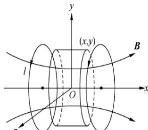
其通过一对彼此平行且同轴的圆形连通线圈，且两线圈间距与圆线圈半径相同，使两线圈内通过方向一致且大小相同的电流，其公共轴中点附近产生较广的均匀磁场。在一维磁场的基础上，还可进行二维、三维组合磁场的叠加，可提供交流磁场或直流磁场，并且电流和磁场具有非常稳定的线性关系。
