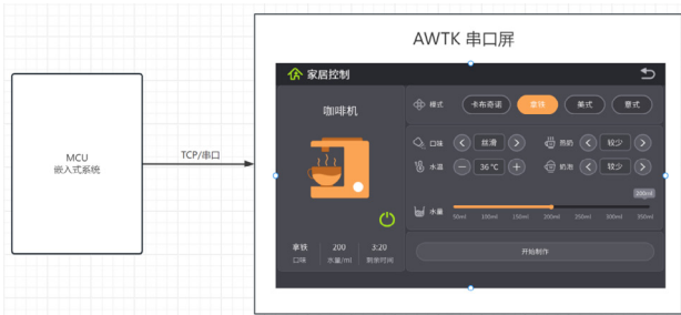
图 1 MCU端与串口屏端连接方式
