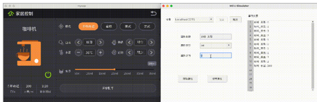
图 5 MCU修改数据自动更新串口屏界面
