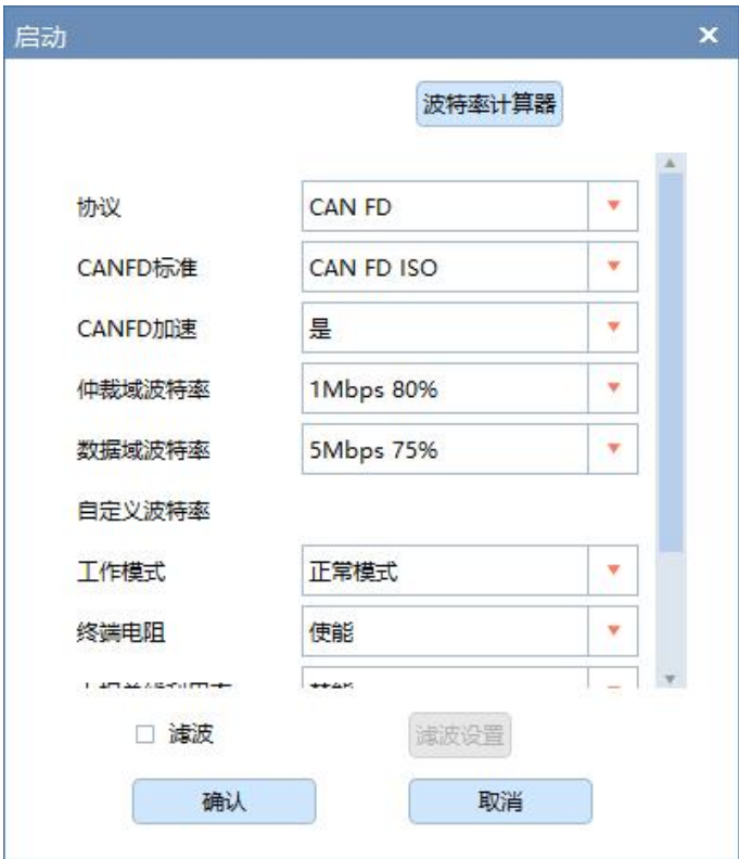
图 4.12 启动 CANFDDTU-200 设备界面
