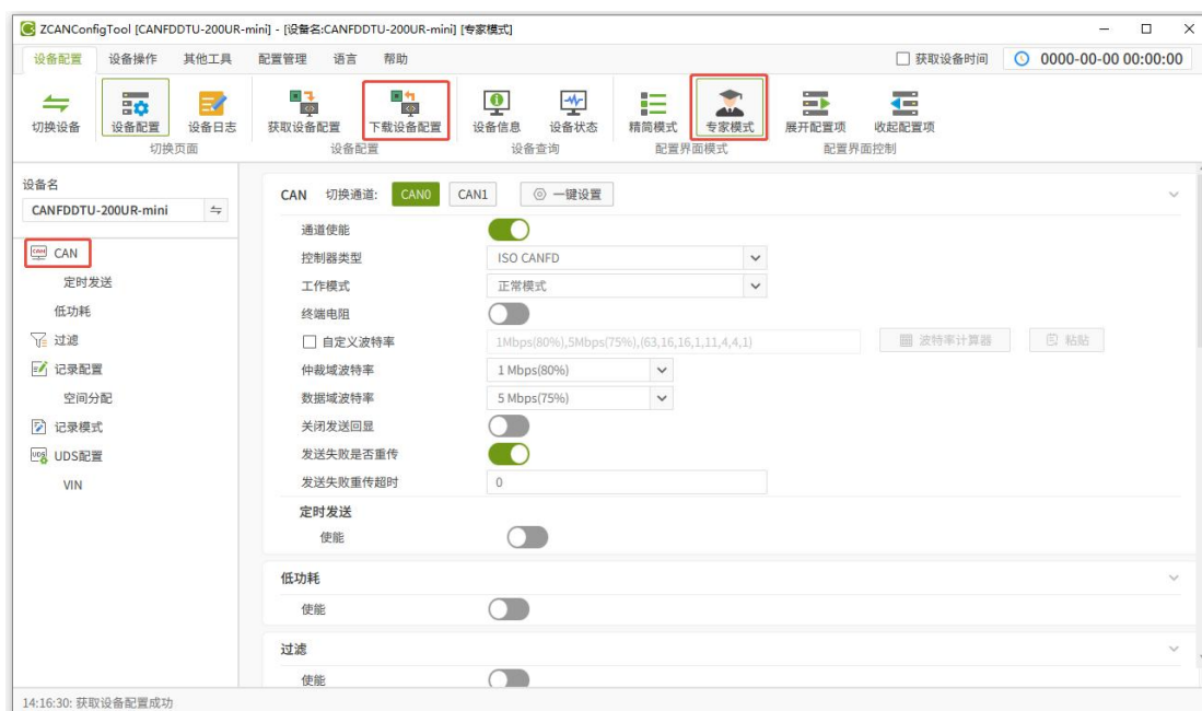
图 4.3 CAN FD 通道配置界面
