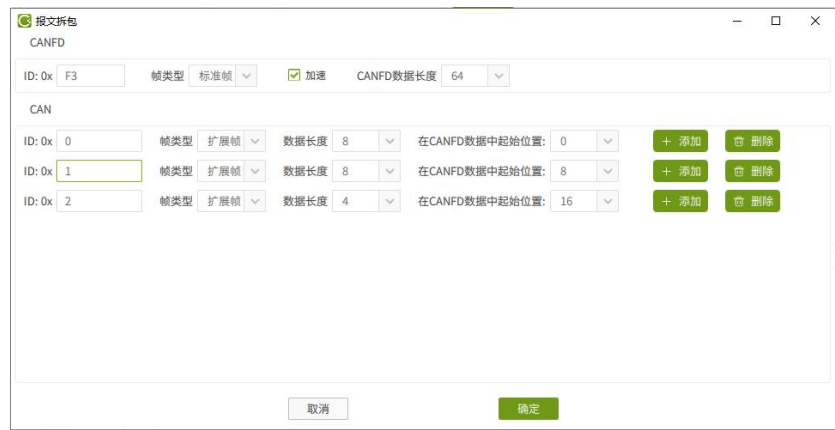
图 6.40 64 字节 CANFD 拆分为 2 个 8 字节 CAN 设置
