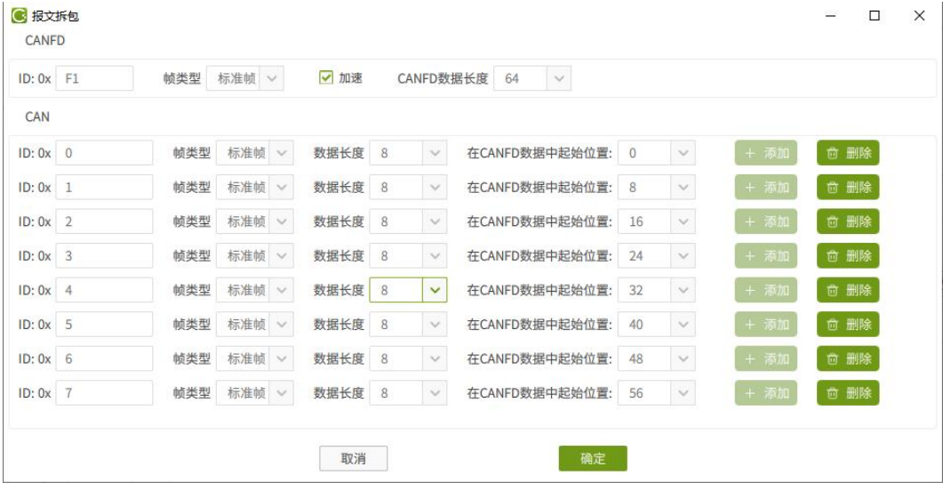
图 6.36 64 字节 CANFD 拆分 8 个 8 字节 CAN 设置
