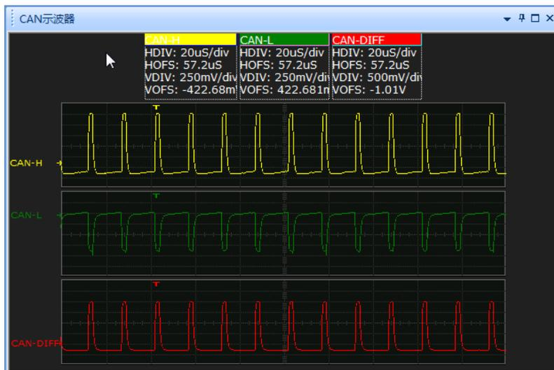
图 8.102 CAN 示波器\_ CHL (4000pf) 测试结果
