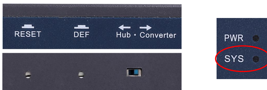
图 2.6 复位按钮、恢复出厂设置按钮及功能转换开关
