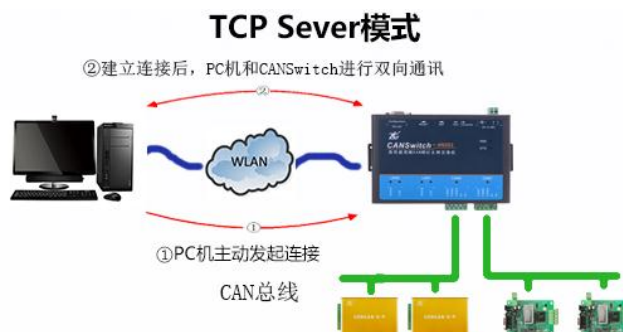
图 4.12 TCP Sever 模式通讯示意图
