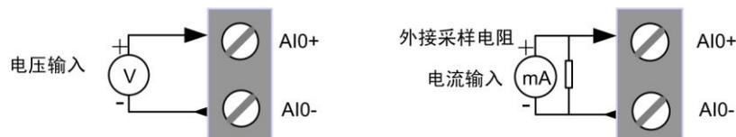
图 2.3 电压测量和电流测量时的接线方法
