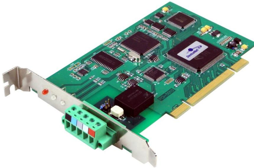
图 1.1 PCI-5010-D DeviceNet 主站卡
