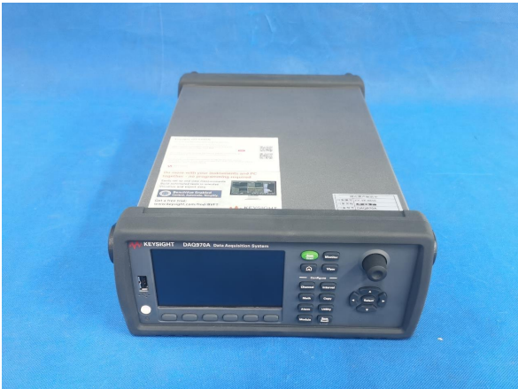
图 2 DAQ970A 数据采集器
