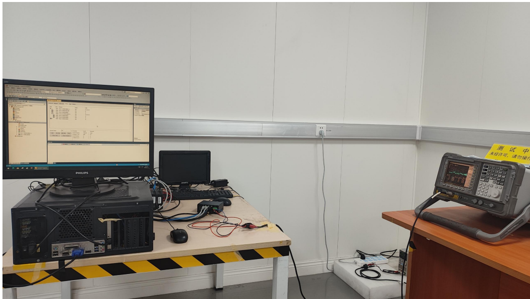
图 5 传导骚扰试验现场配置图
