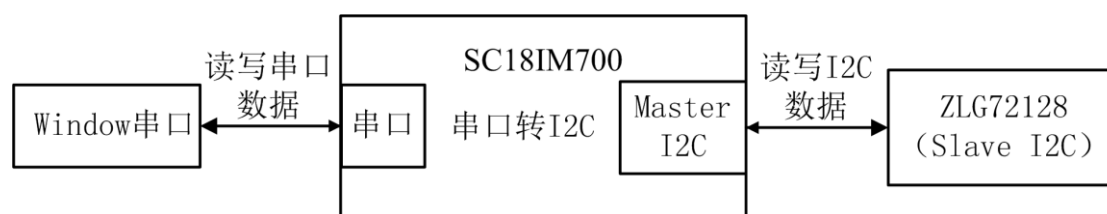
图 7.1 SC18IM700 通信流程图
