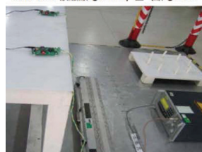
快速瞬变脉冲群测试: 信号端口 \pm 4\text{KV}
