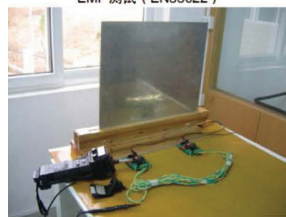
ESD Test 接触放电 \pm 4\text{Kv} , 空气放电 \pm 8\text{kv}
