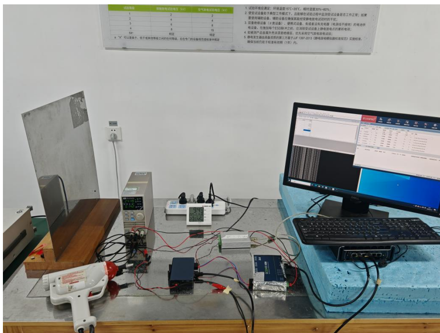
图 2 ESD 试验现场配置图
