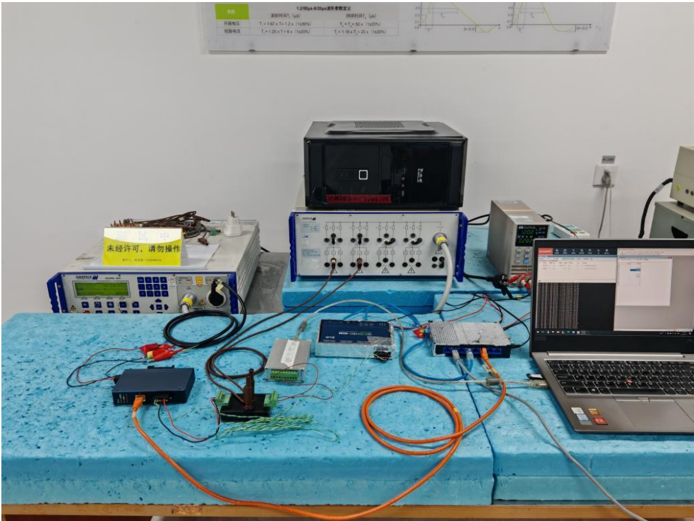
图 7 浪涌试验现场配置图
