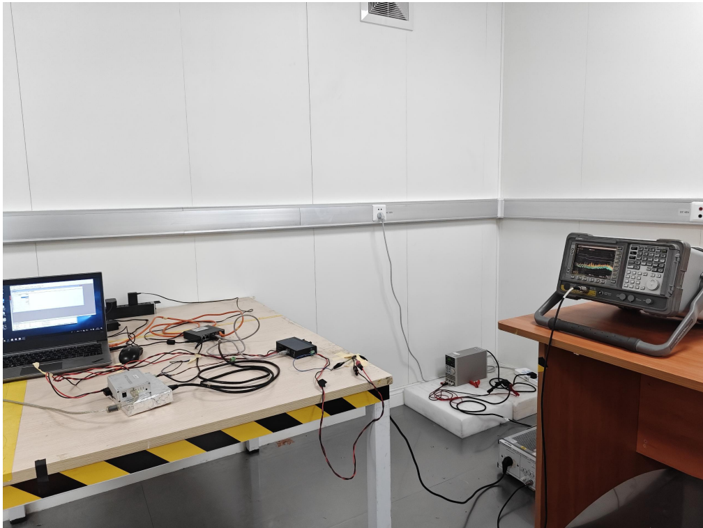
图 9 传导骚扰试验现场配置图
