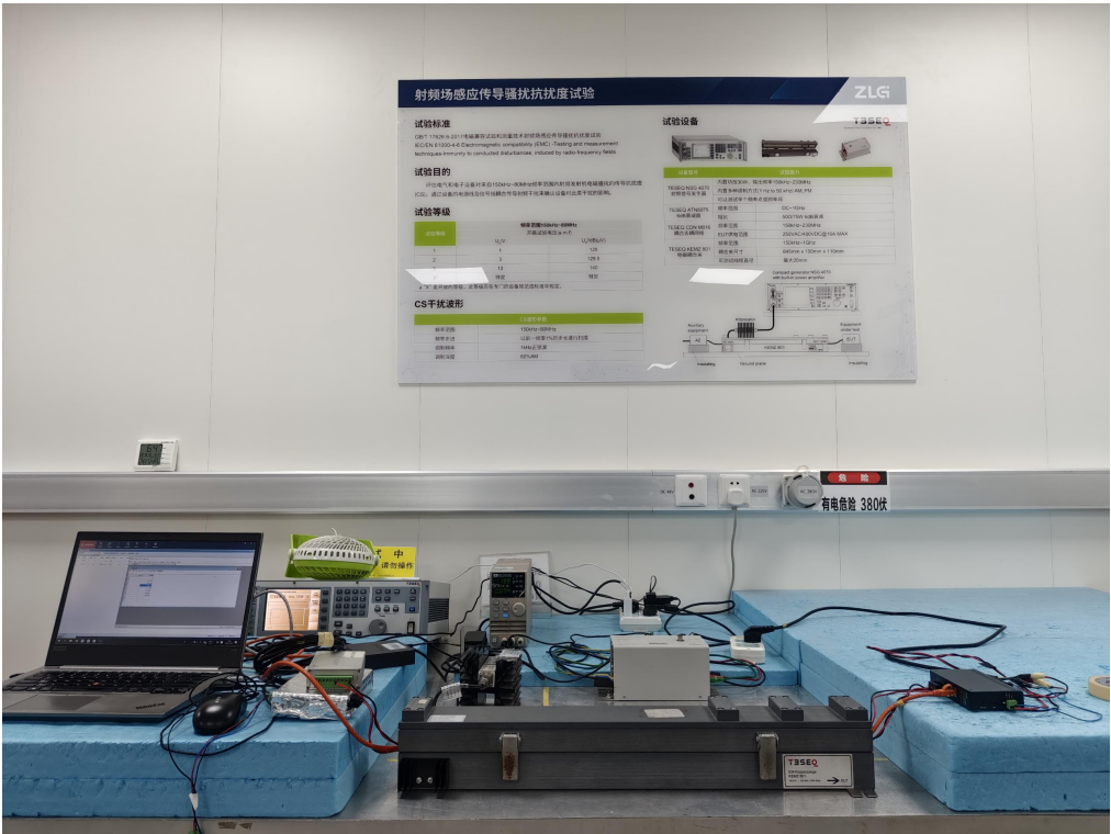
图 8 CS 试验现场配置图
