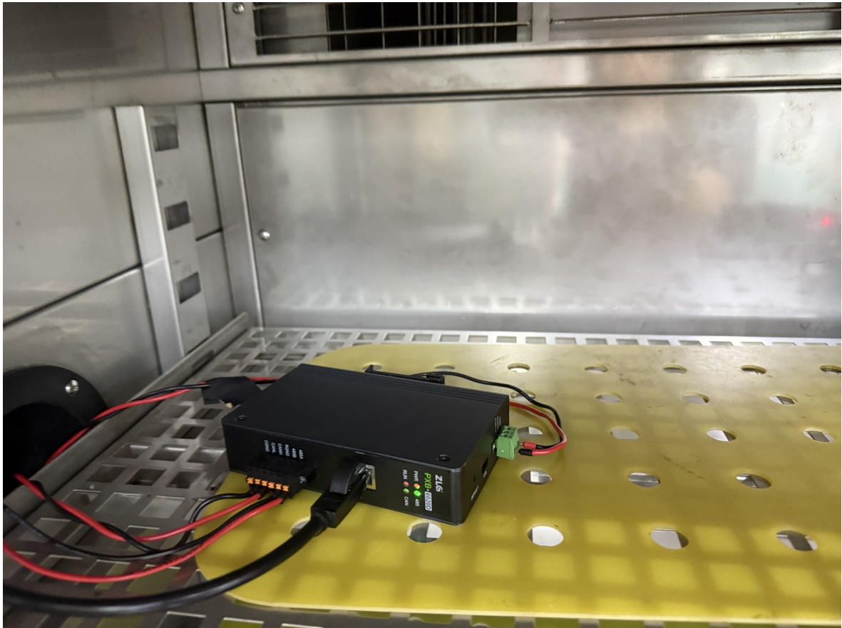
图 3 样机环境试验
