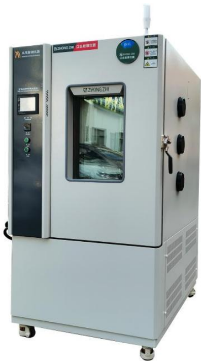
图 1 CZ-A-225G 高低温湿热试验箱
