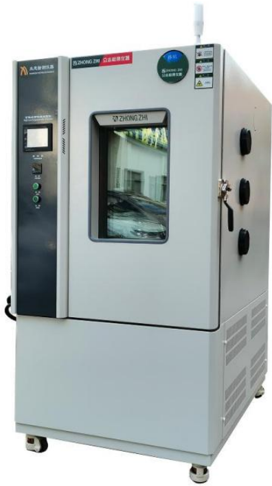
图 1 CZ-A-225G 高低温湿热试验箱
