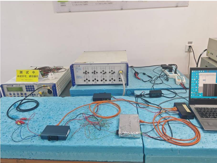
图 5 浪涌试验现场配置图
