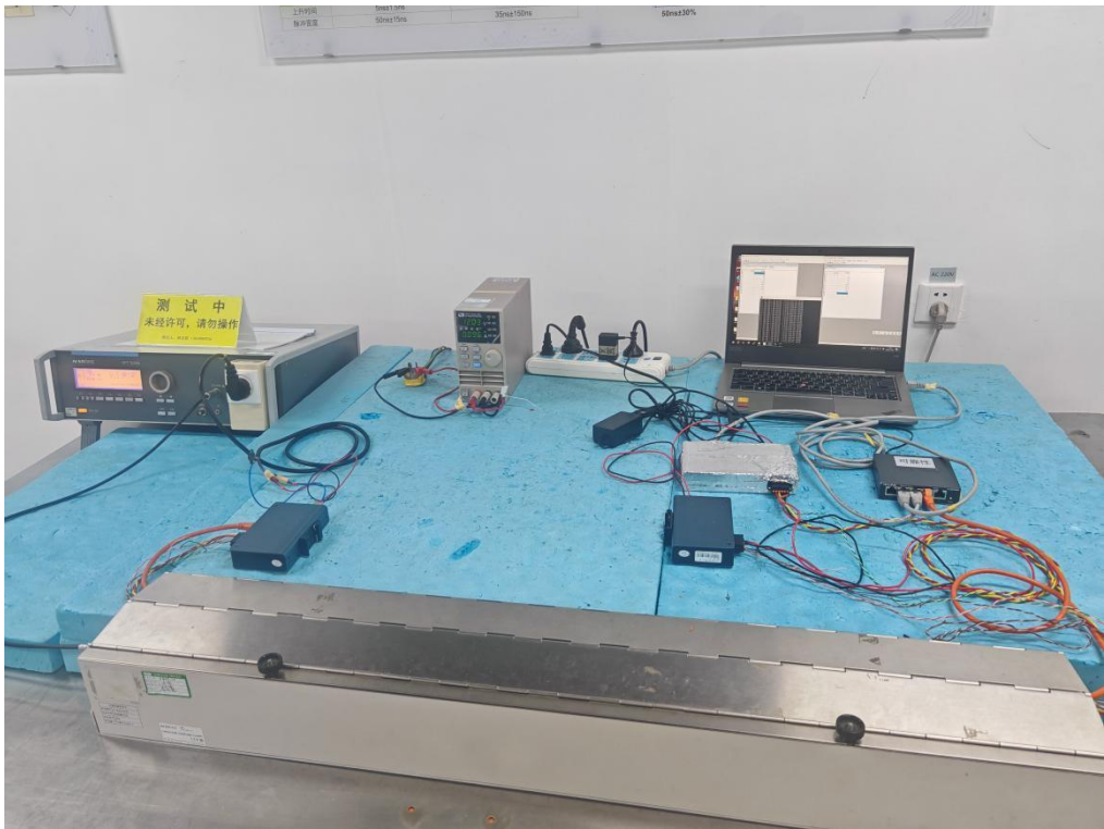
图 4 EFT 试验现场配置图
