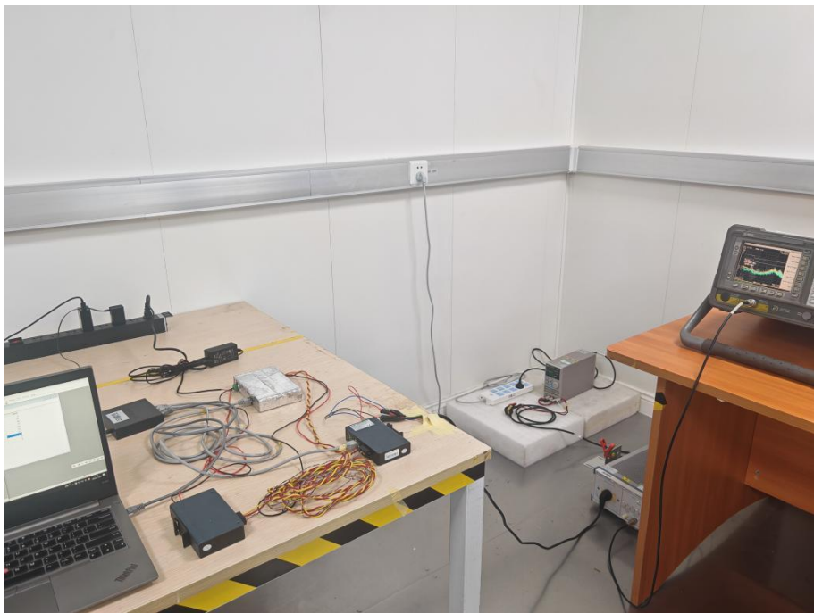
图 6 传导骚扰试验现场配置图
