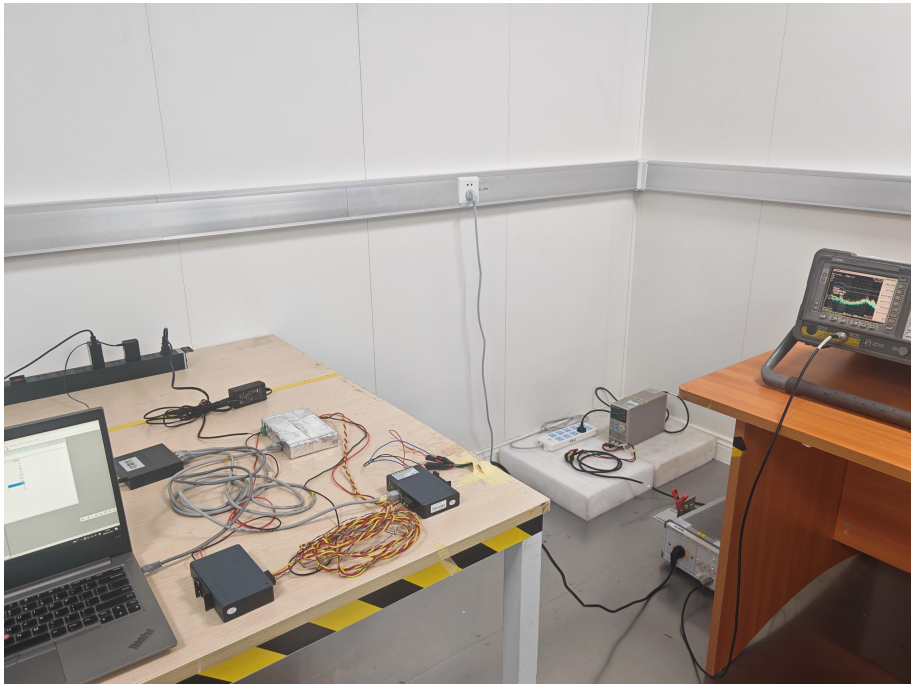
图 6 传导骚扰试验现场配置图
