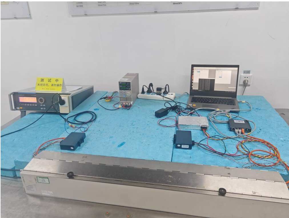
图 4 EFT 试验现场配置图
