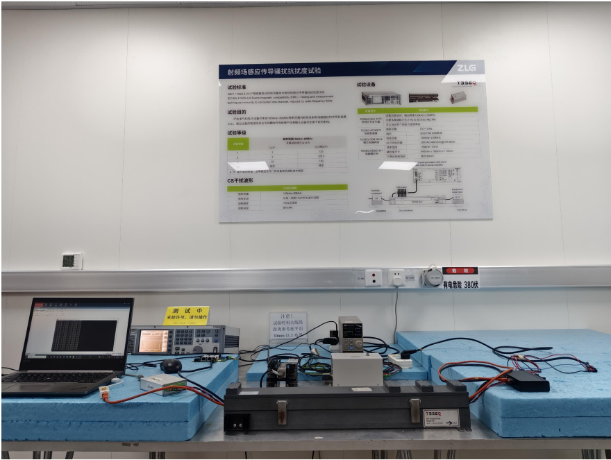
图 13 传导骚扰试验配置
