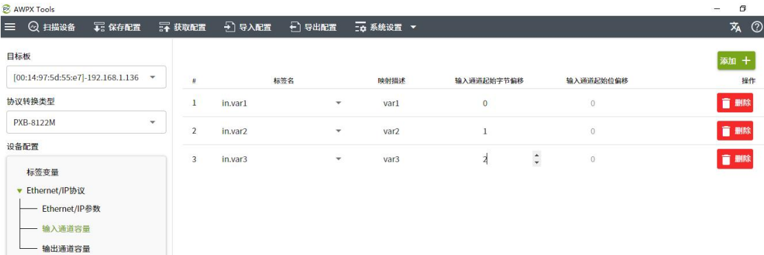
图 5.3 Ethernet/IP 输入通道映射
