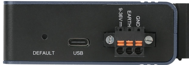
图 2.2 顶部接口定义示意图
