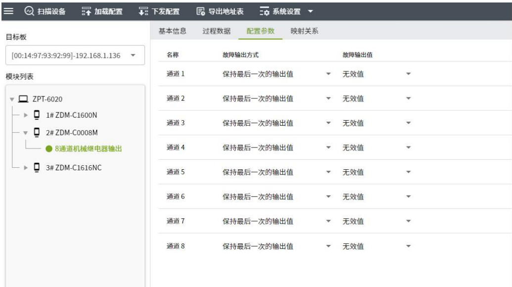
图 5.1 8 通道机械继电器输出配置界面
