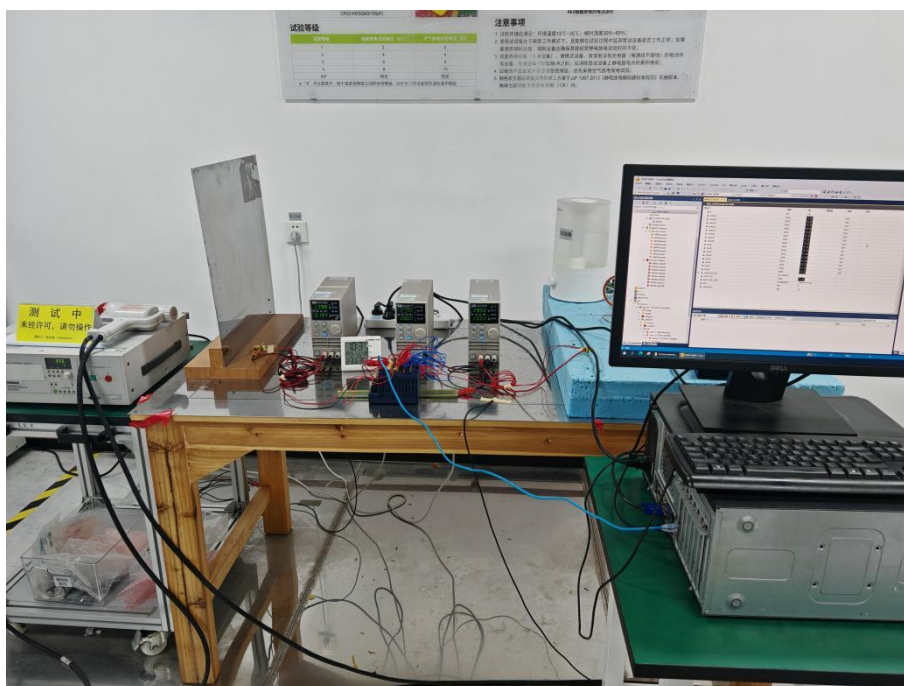
图 2 ESD 试验现场配置图
