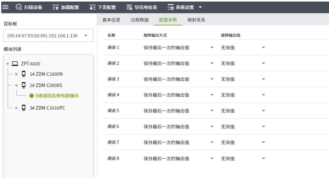
图 5.1 8 通道固态继电器输出配置界面
