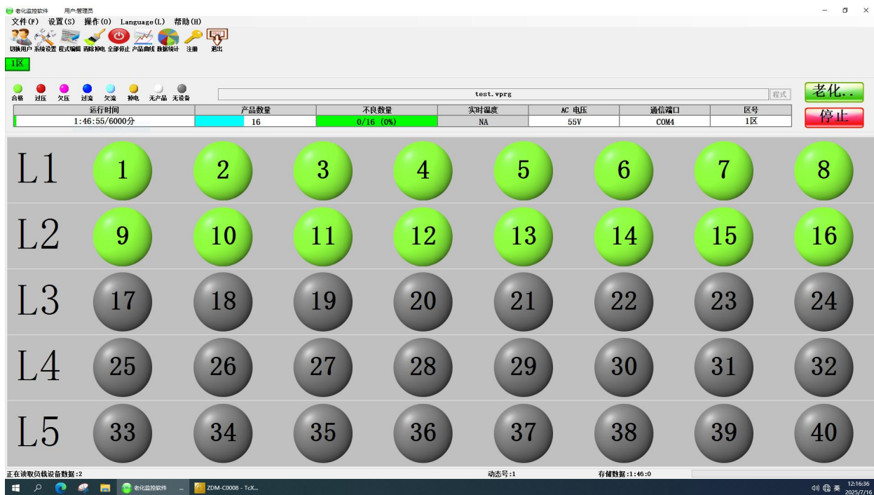
图 9 样机在高温试验时第一次启动运行检查功能正常 (30VDC 供电)
