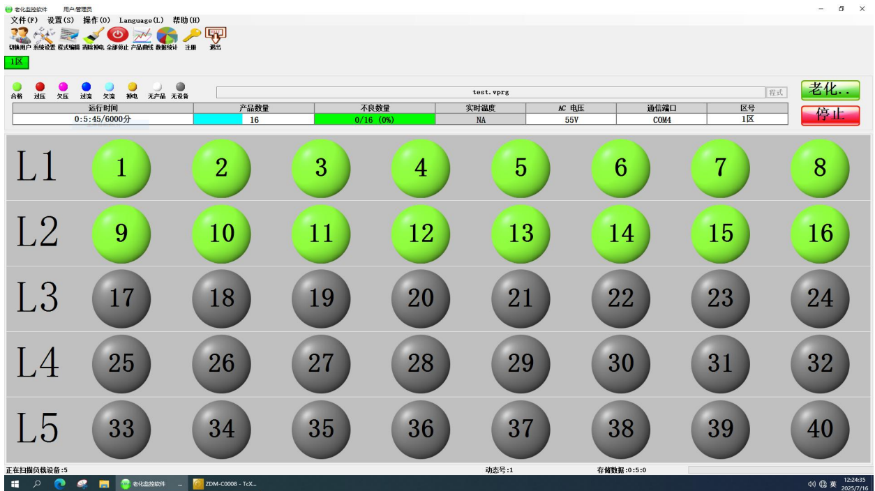
图 10 样机在高温试验时第二次启动运行检查功能正常 (18VDC 供电)
