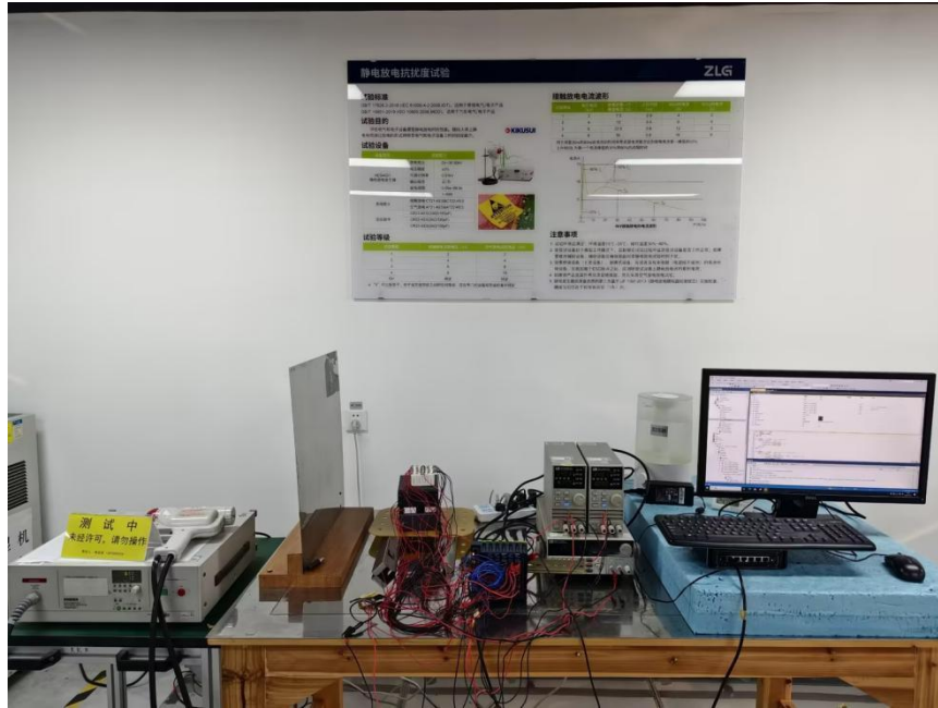
图 2 ESD 试验现场配置图
