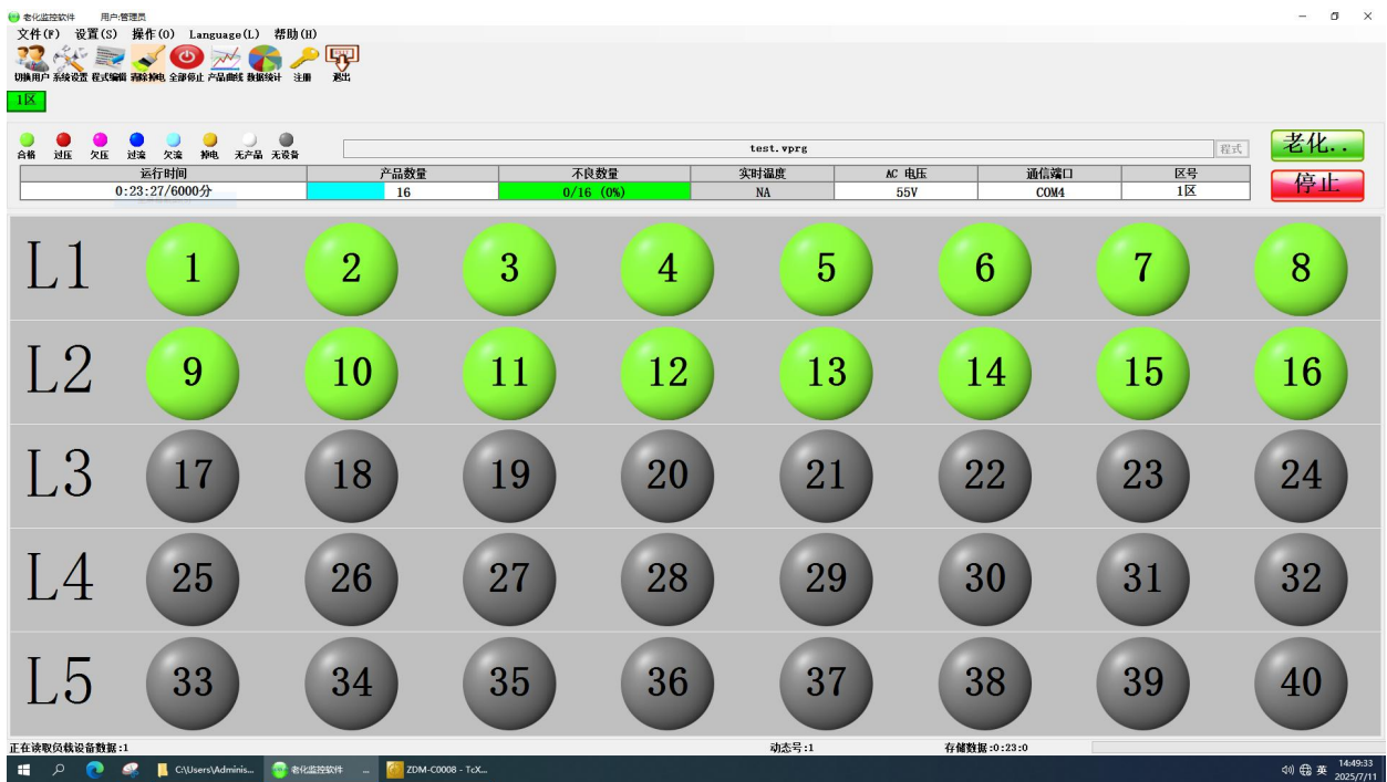
图 10 样机在高温试验时第二次启动运行检查功能正常 (18VDC 供电)
