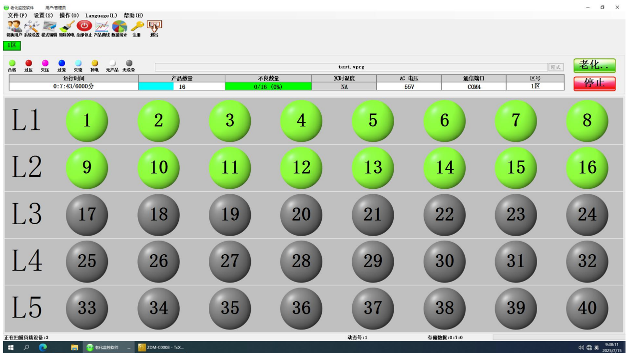
图 13 样机在湿热试验时第二次启动运行检查功能正常 (18VDC 供电)
