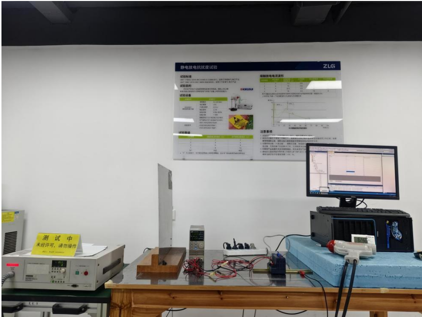
图 2 ESD 试验现场配置图
