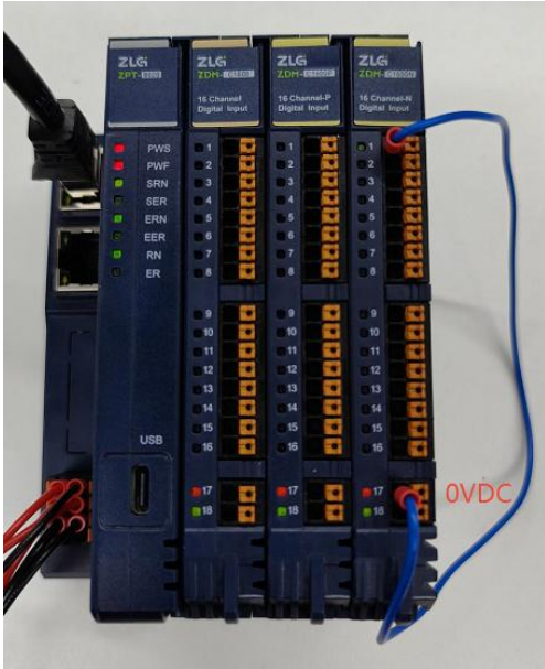
图 6.1 0V 低电平输入
