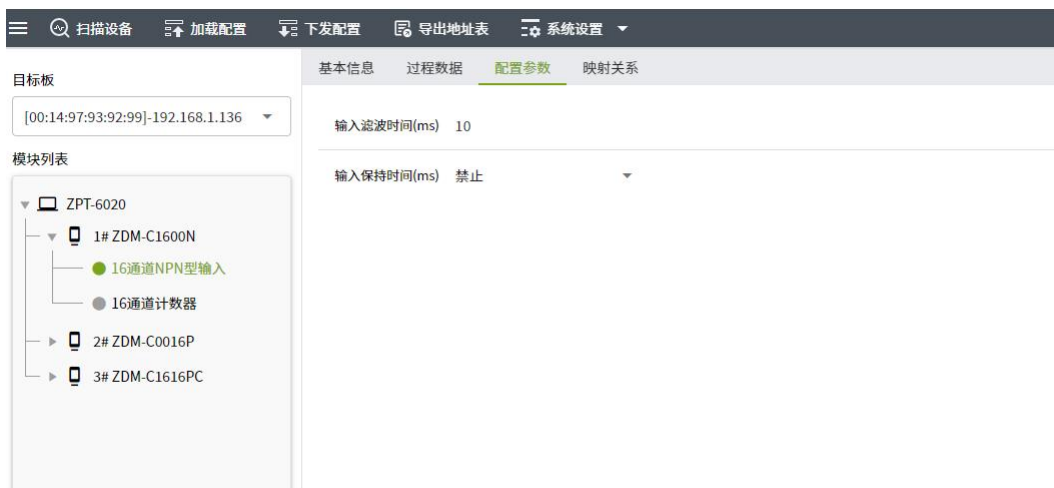
图 5.1 16 通道 NPN 型输入配置界面
