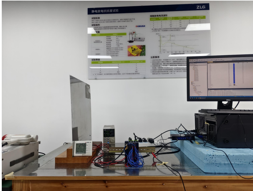
图 2 ESD 试验现场配置图
