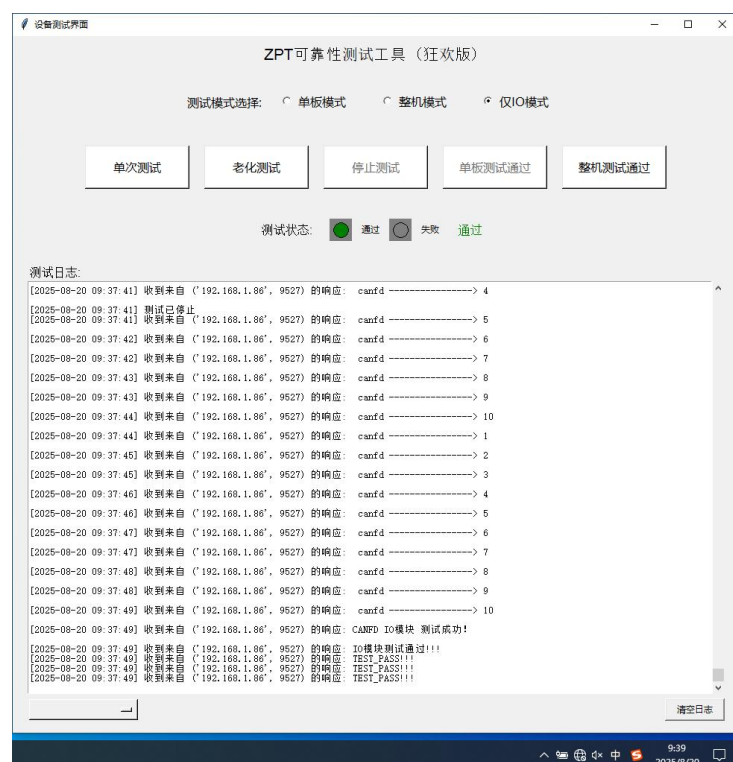
图 17 样机在湿热试验时第三次检查功能正常 (30VDC 供电)
