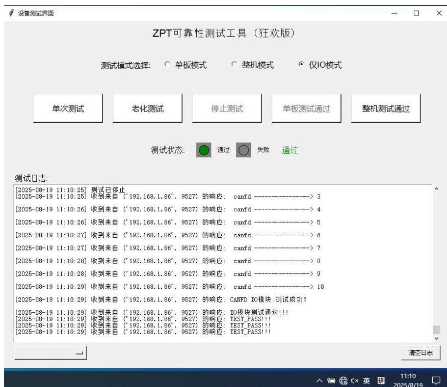
图 12 样机在低温试验时第一次检查功能正常 (18VDC 供电)
