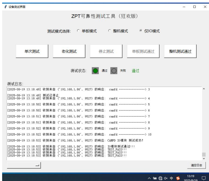
图 13 样机在低温试验时第二次检查功能正常 (24VDC 供电)
