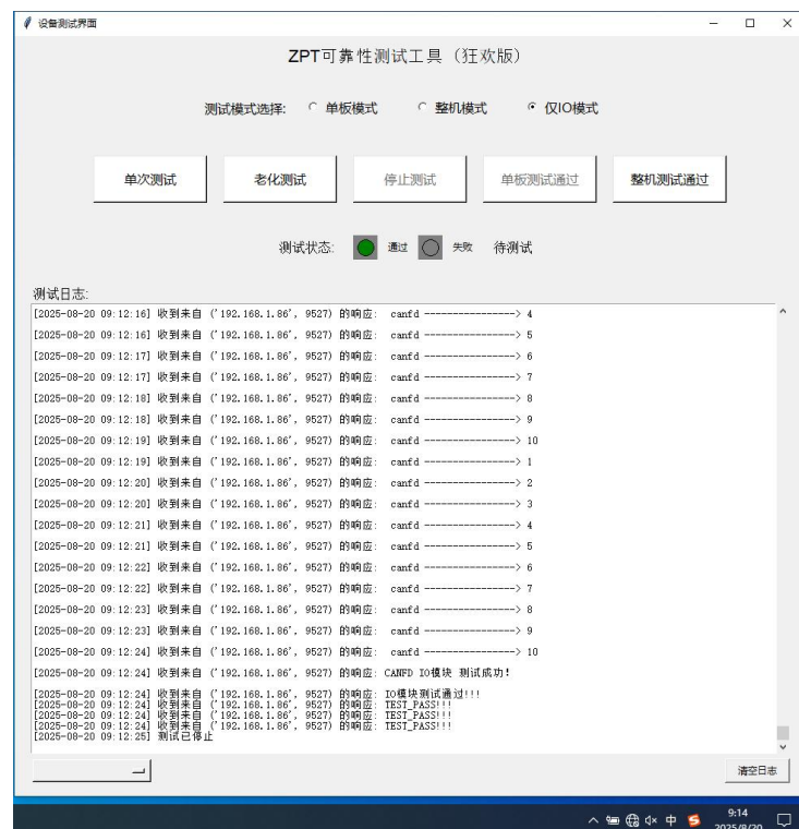
图 16 样机在湿热试验时第二次检查功能正常 (18VDC 供电)
