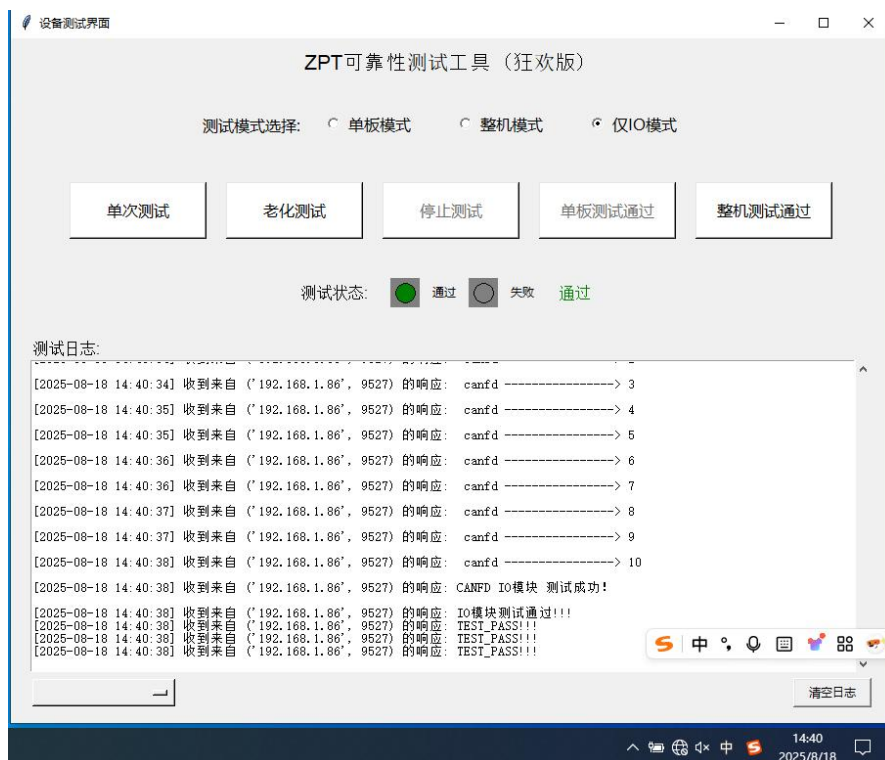
图 10 样机在高温试验时第三次检查功能测试正常 (30VDC 供电)
