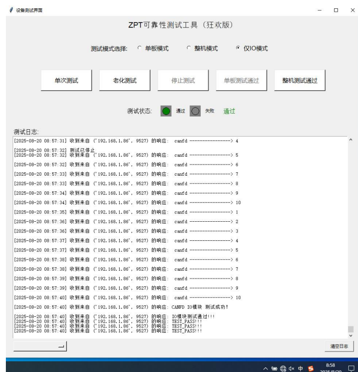
图 15 样机在湿热试验时第一次检查功能正常 (24VDC 供电)
