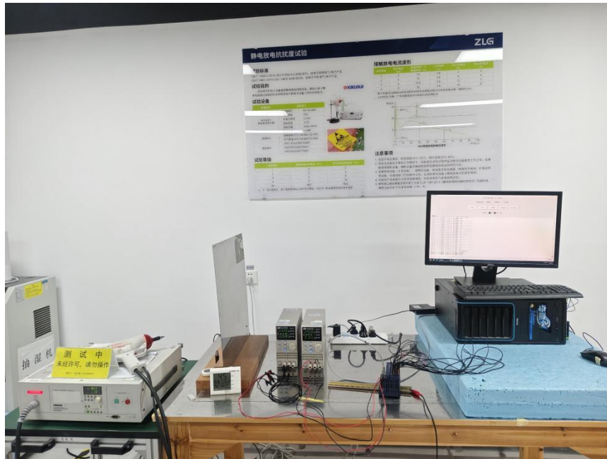
图 2 ESD 试验现场配置图
