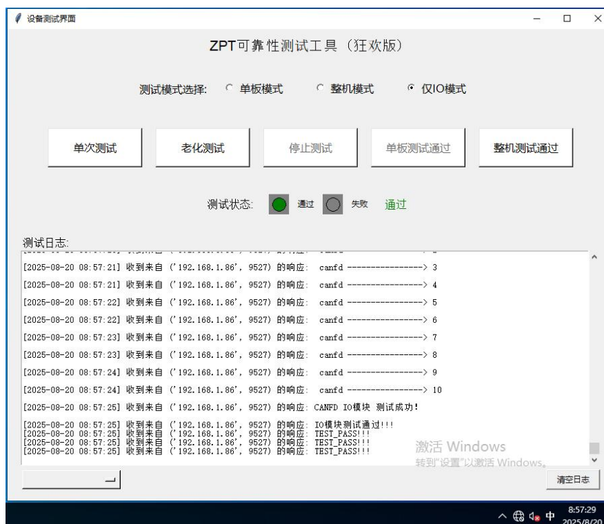
图 15 样机在湿热试验时第一次检查功能正常 (24VDC 供电)
