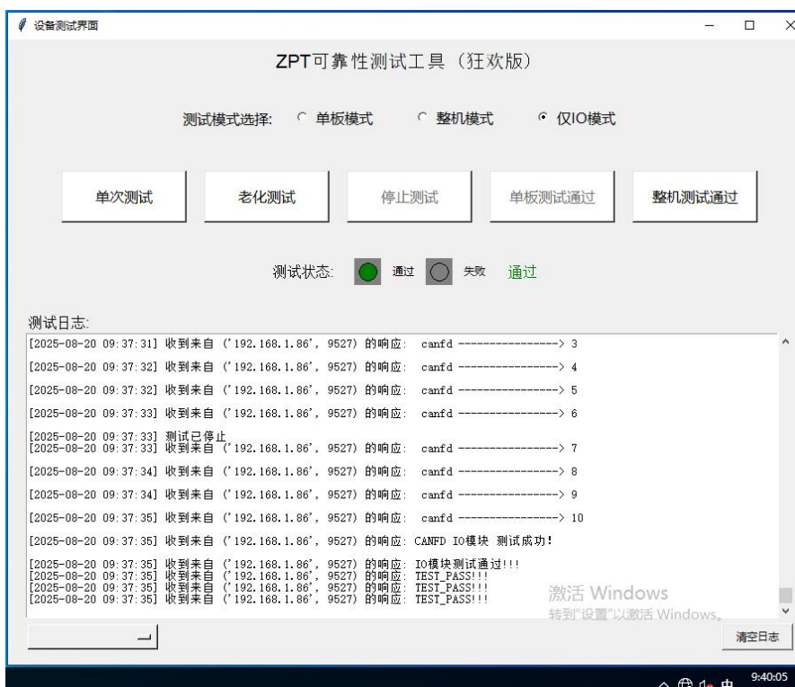
图 17 样机在湿热试验时第三次检查功能正常 (30VDC 供电)
