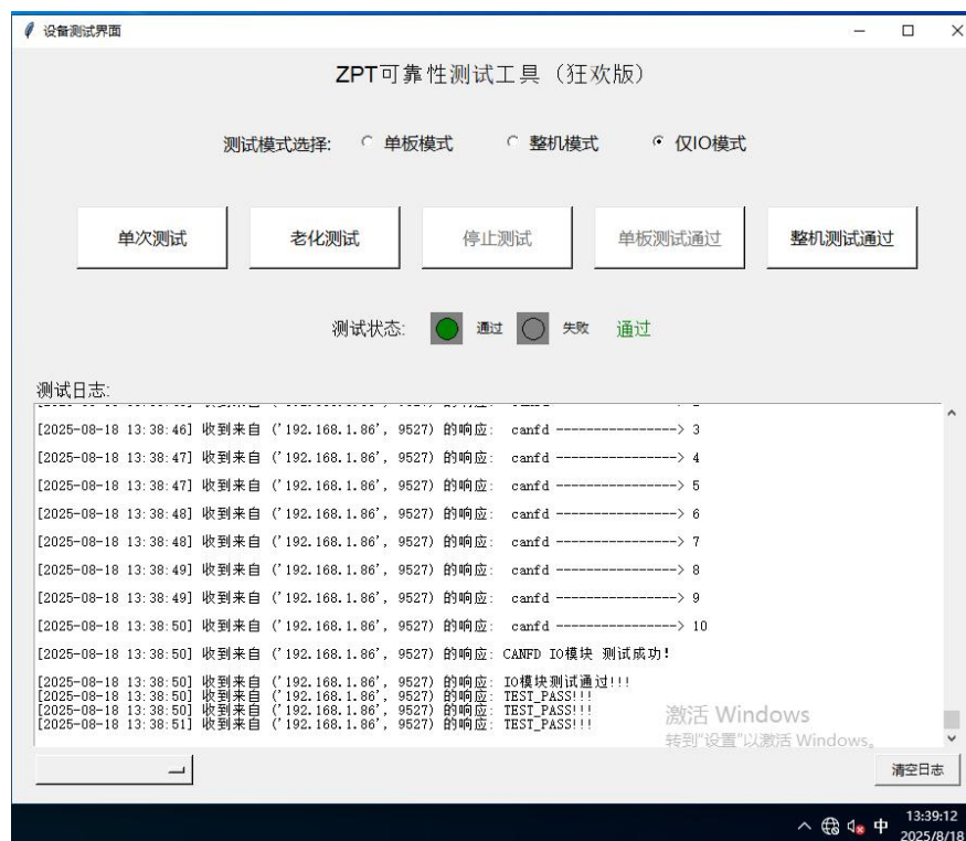
图 9 样机在高温试验时第二次检查功能测试正常（18VDC 供电）
