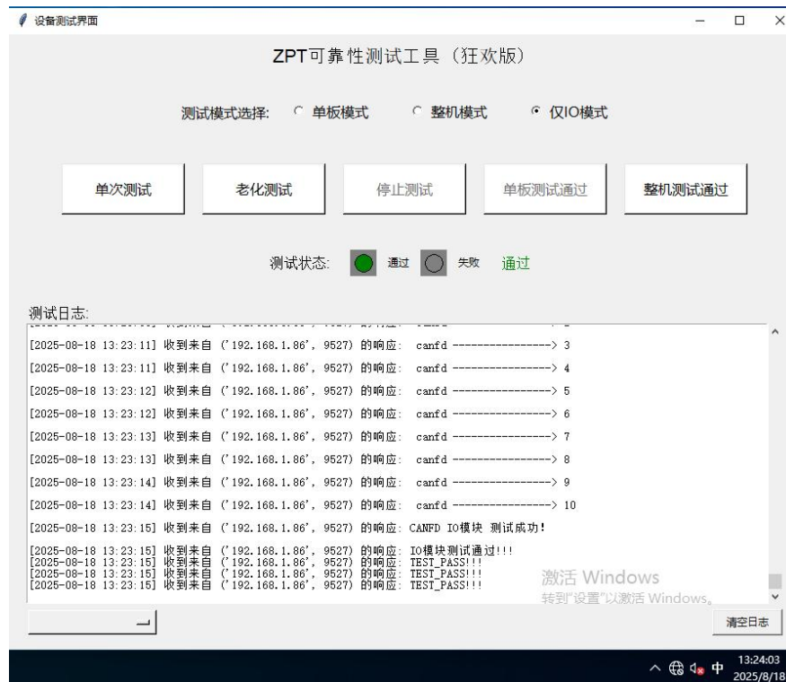
图 8 样机在高温试验时第一次检查功能测试正常（24VDC 供电）
