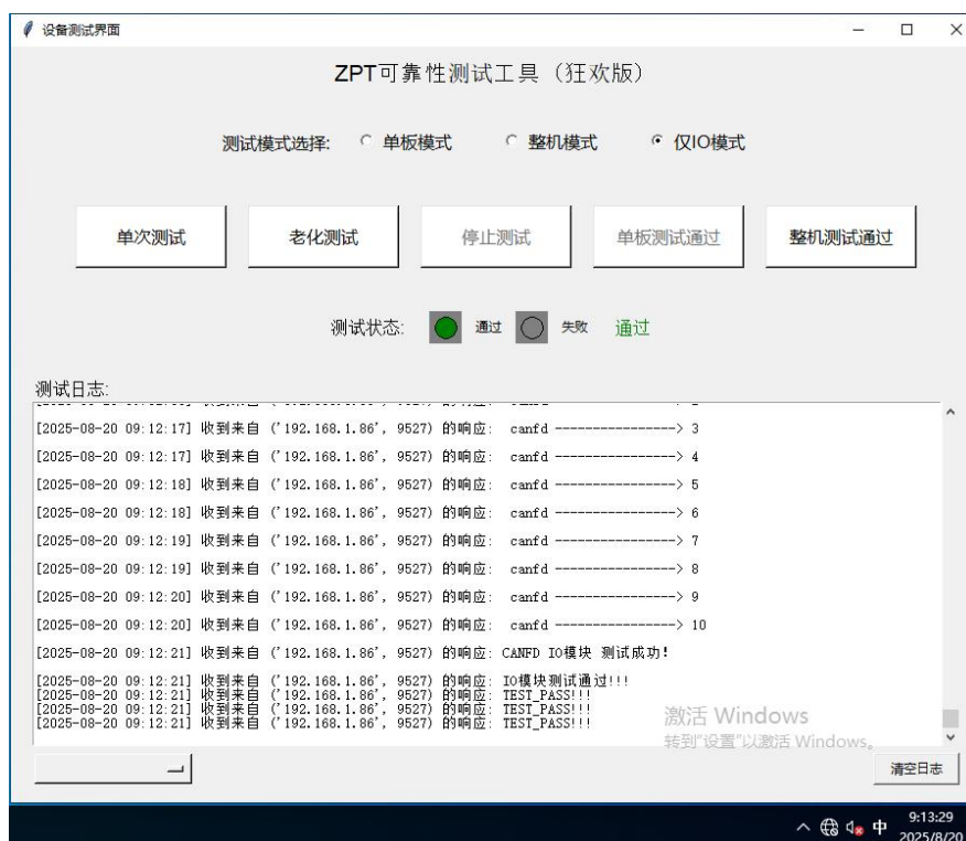
图 16 样机在湿热试验时第二次检查功能正常 (18VDC 供电)
