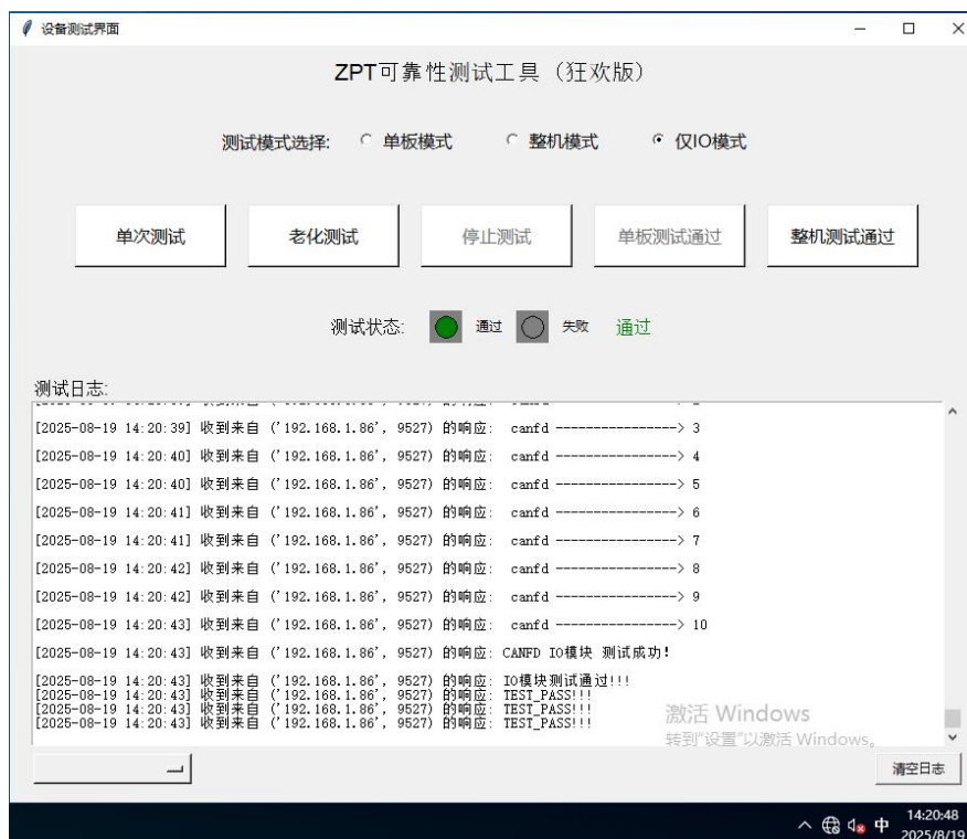
图 14 样机在低温试验时第三次检查功能正常 (30VDC 供电)
