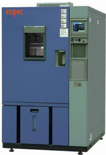
图 1 高低温交变湿热试验箱
