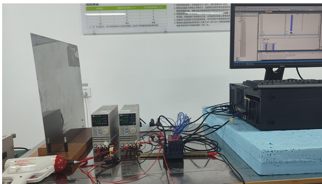
图 2 ESD 试验现场配置图
