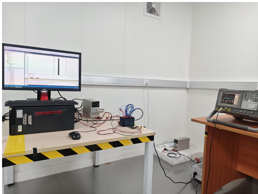
图 10 传导骚扰试验配置
