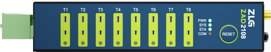
图 3.4 热电偶采集端接口图
