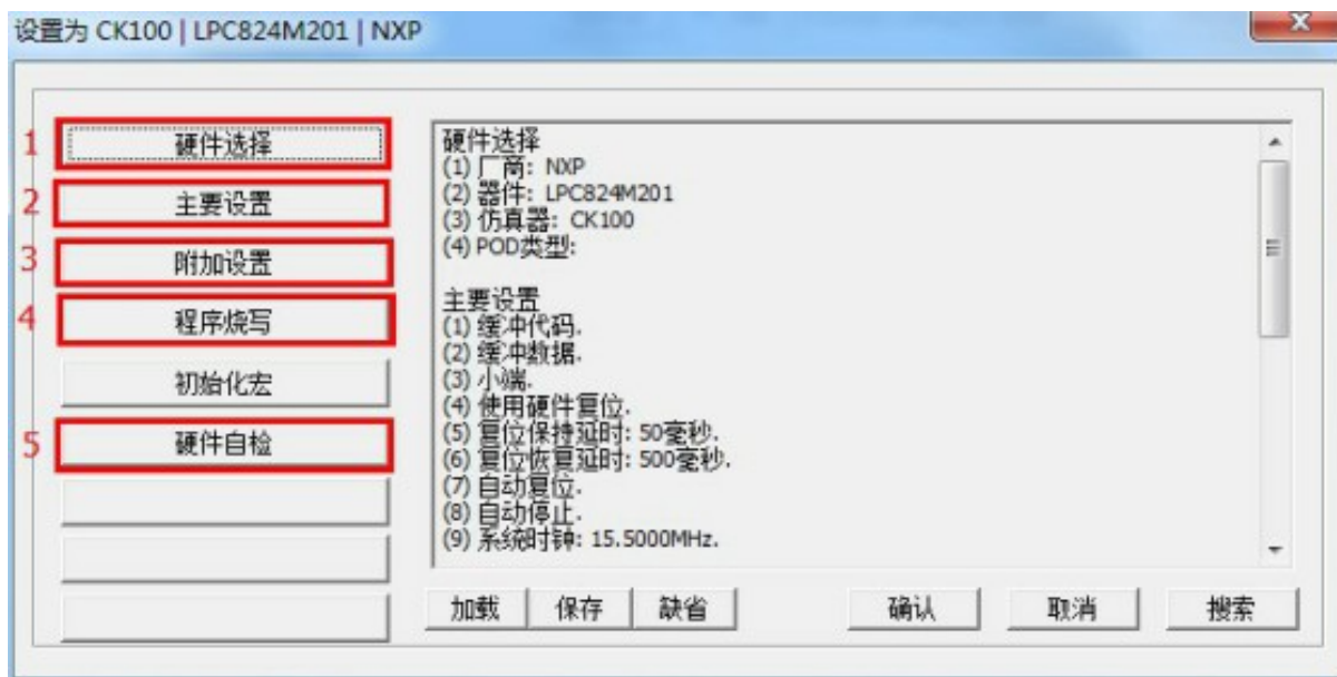
图 74: TKScope Debug for ARM 配置顺序
