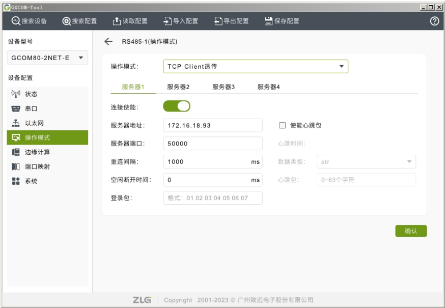
图 4.2 TCP Client 透传配置
