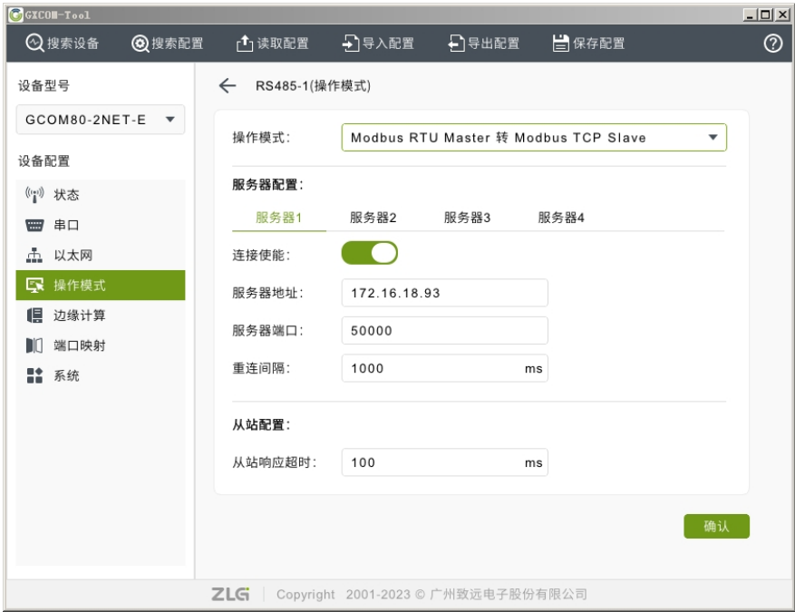
图 4.27 ModbusRTU Master 转 ModbusTCP Slave 模式配置
