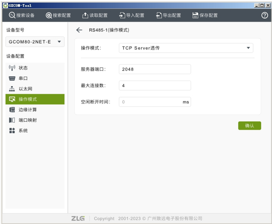
图 4.8 TCP Server 透传配置
