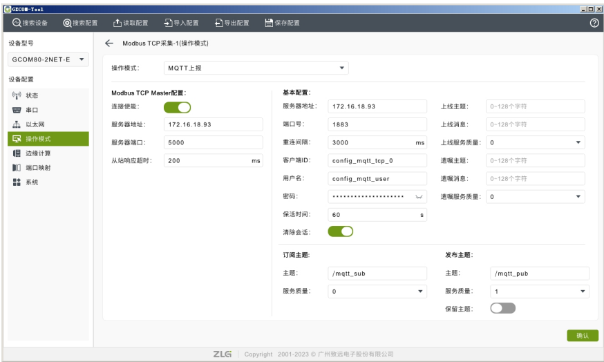
图 4.39 ModbusTCP 采集 MQTT 上报模式配置
