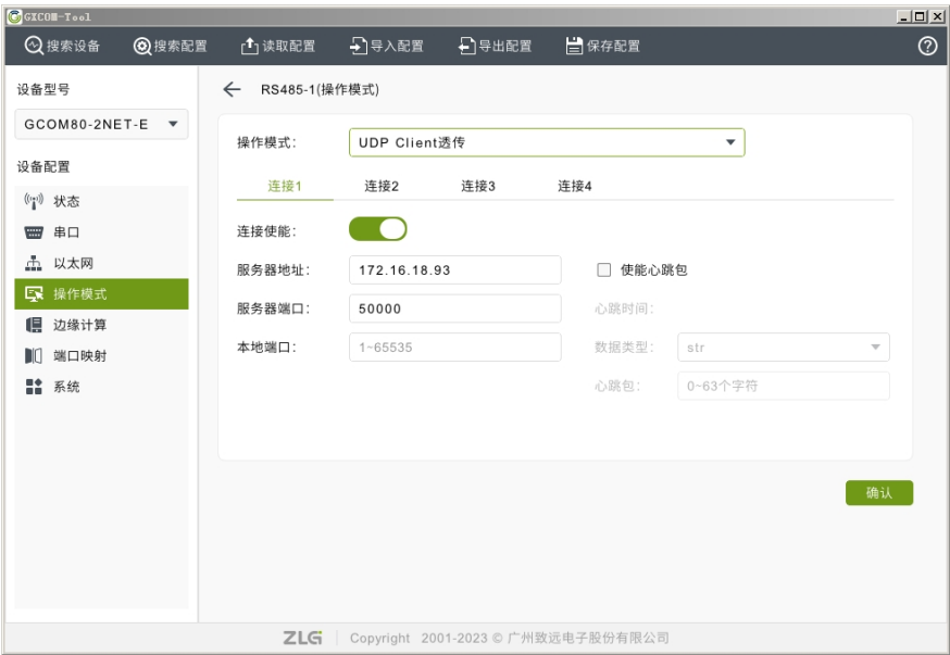
图 4.12 UDP Client 透传配置
