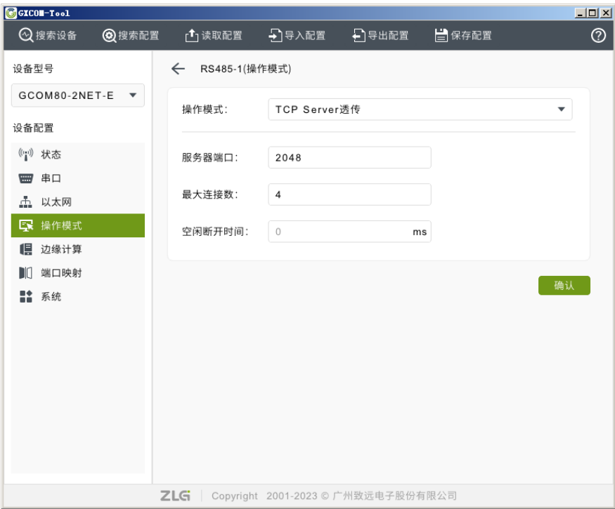
图 3.12 TCP Server 透传配置
