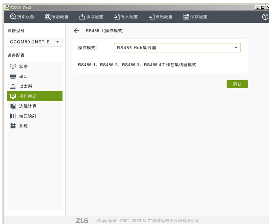
图 3.35 RS485 Hub 模式配置
