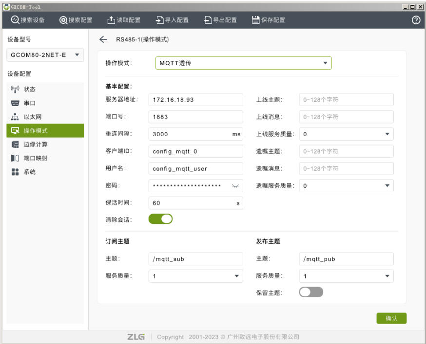
图 3.21 MQTT 透传配置
