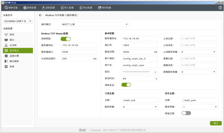
图 3.39 ModbusTCP 采集 MQTT 上报模式配置
