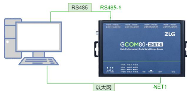
图 2.3 硬件连接示意图
