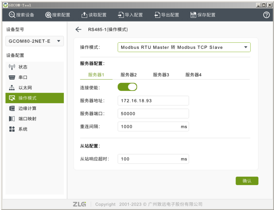
图 3.27 ModbusRTU Master 转 ModbusTCP Slave 模式配置
