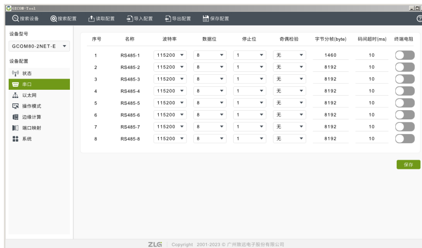
图 3.3 串口参数配置
