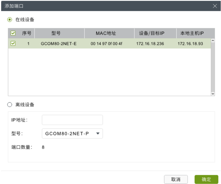
图 6.14 在线设备安装
