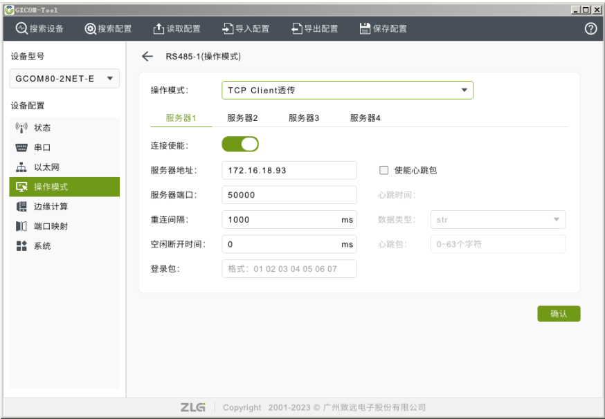
图 3.2 TCP Client 透传配置
