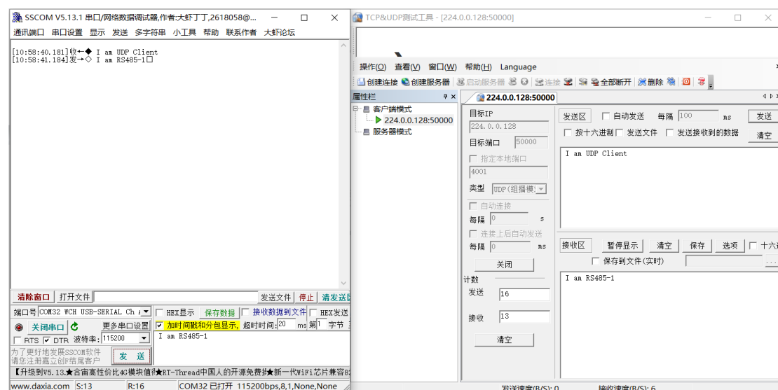
图 3.18 串口与 UDP Client 数据收发
