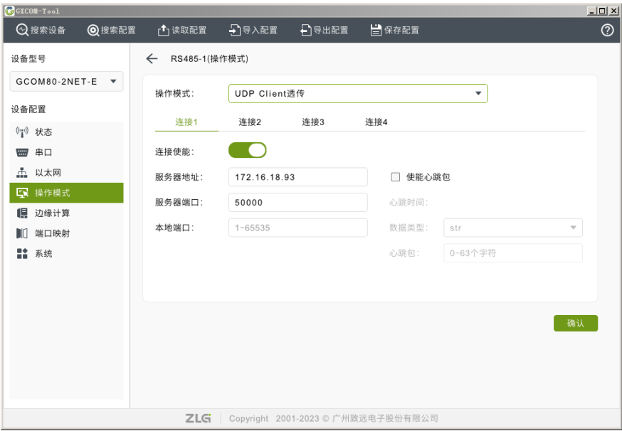
图 3.8 UDP Client 透传配置
