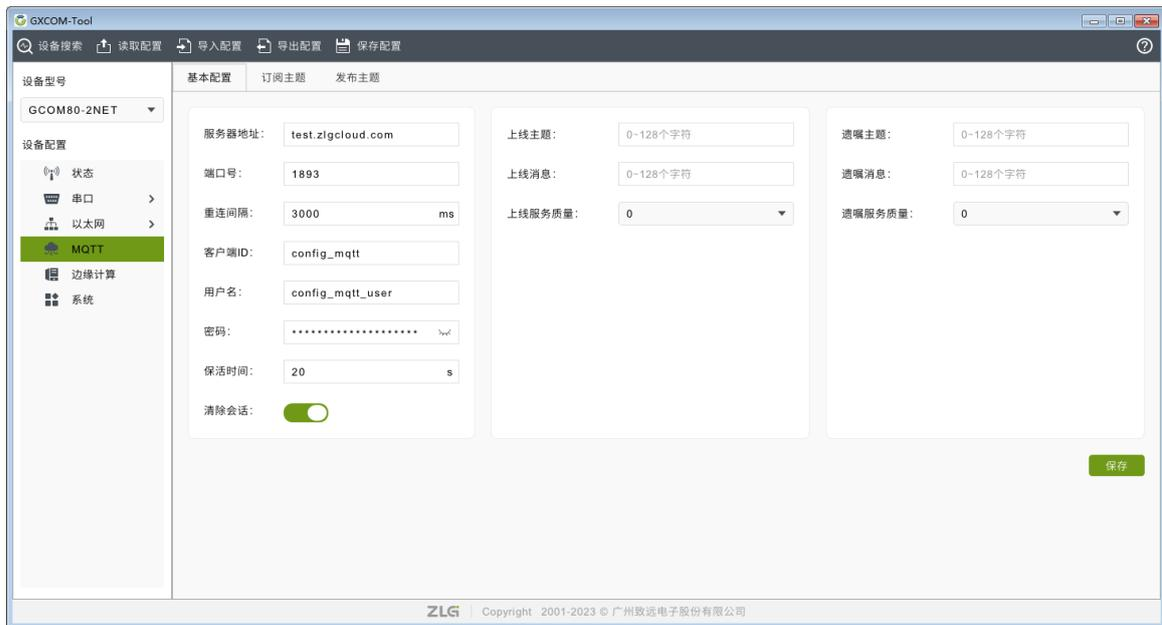
图 2.8 MQTT 客户端参数配置
