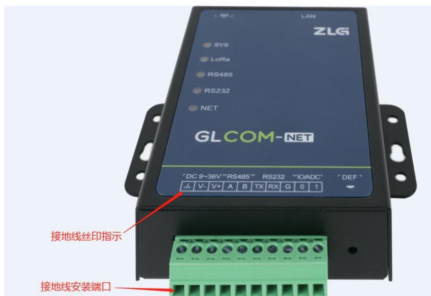
图 6.4 推荐接地线安装方式
