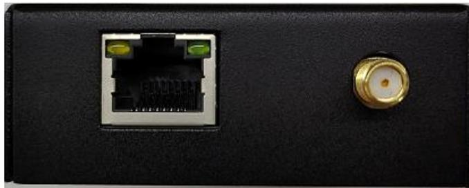
图 3.2 GLCOM-NET 网关上顶面接口图
