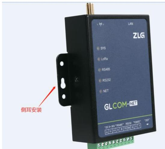
图 6.2 推荐安装方式一
