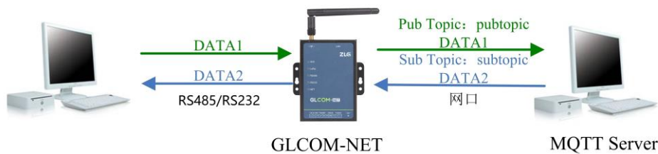
图 4.33 串口与 MQTT 透传应用示意图
