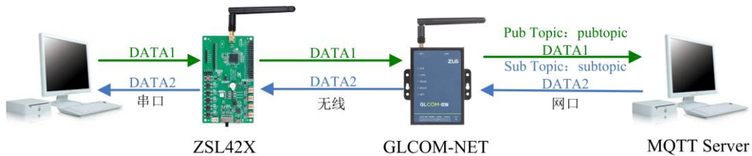
图 4.7 无线与 MQTT 透传应用示意图
