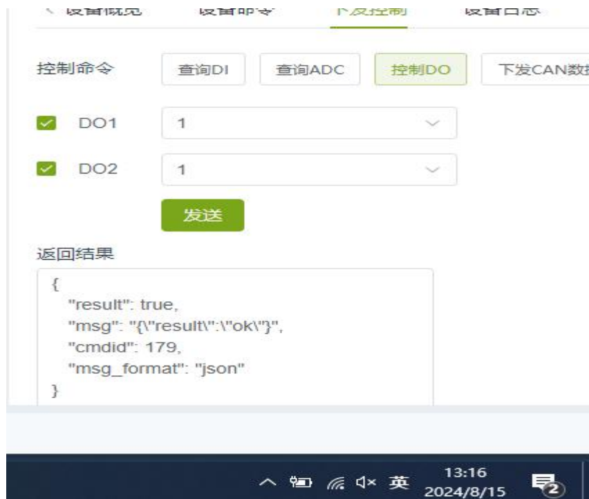
图 13 样机在低温试验时 DO 接口第一次启动运行检查功能正常 (9VDC 供电)
