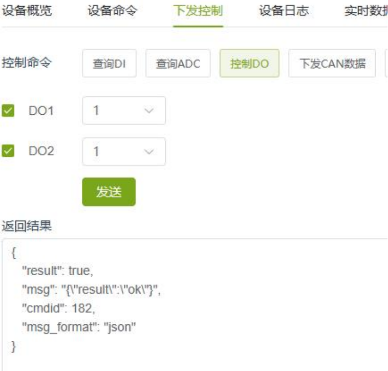
图 10 样机在温度变化时 DO 接口运行检查功能正常（12VDC 供电）
