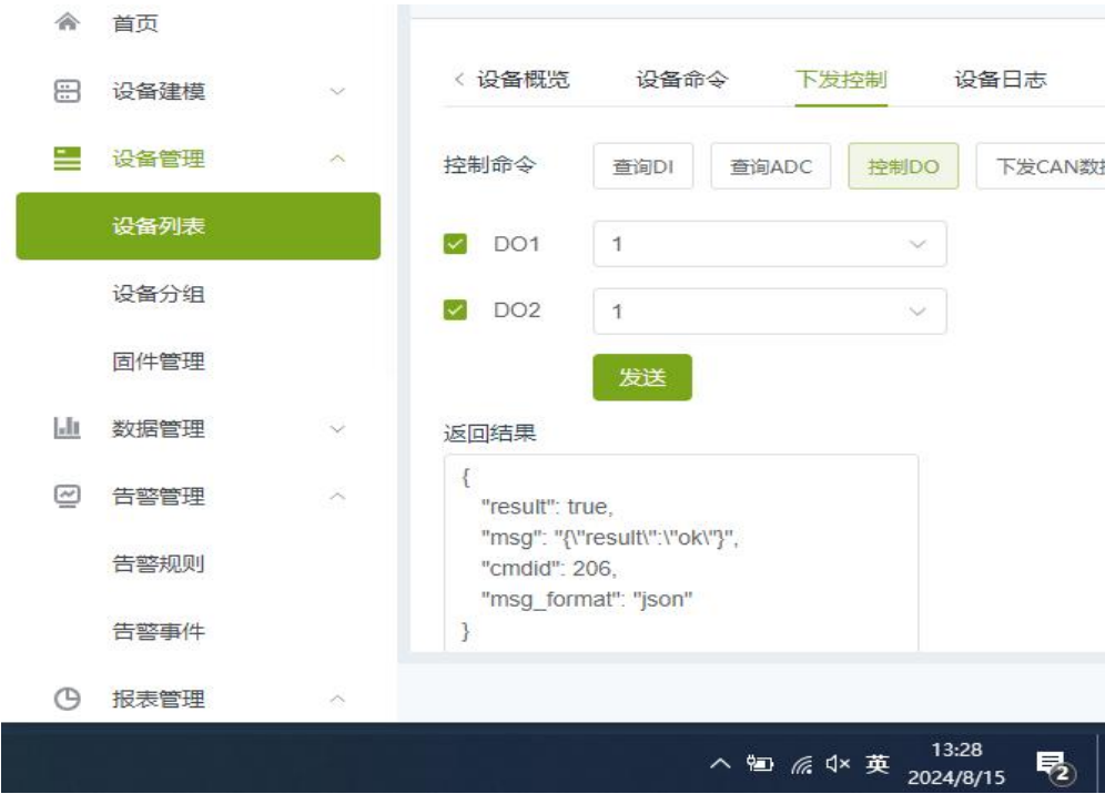
图 20 样机在低温试验时 DO 接口第二次启动运行检查功能正常（12VDC 供电）
