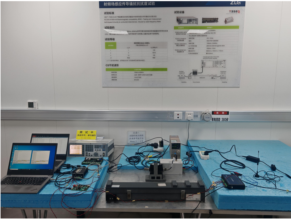
图 9 CS 试验现场配置图
