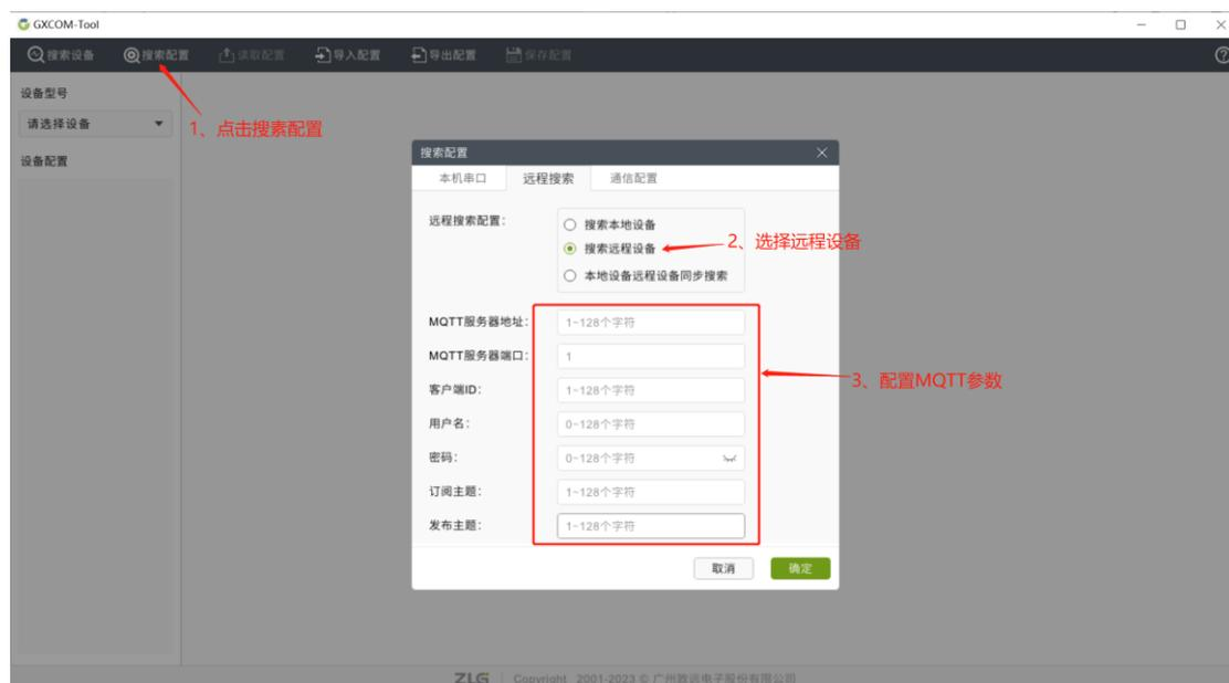
图 3.24 GXCOM-Tool 远程配置
