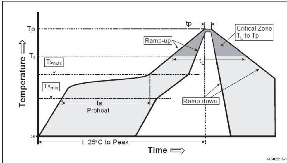
图 8.1 推荐生产回流温度曲线
