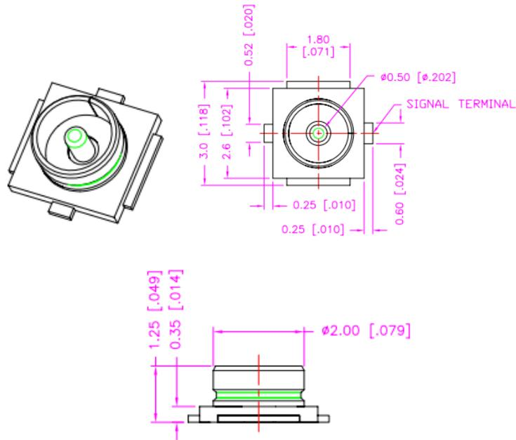
图 9.2 外接连接器参考尺寸图
