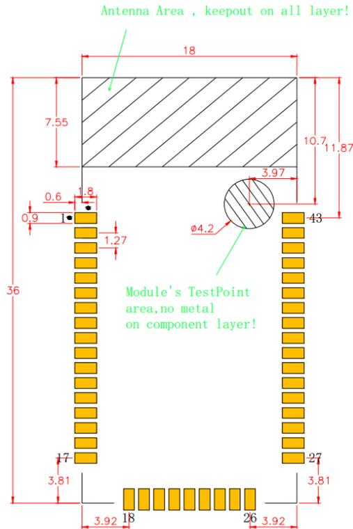
图 9.3 PCB 布线净空区域示意图
