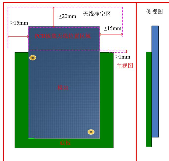
图 9.1 PCB 板载天线周围净空区
