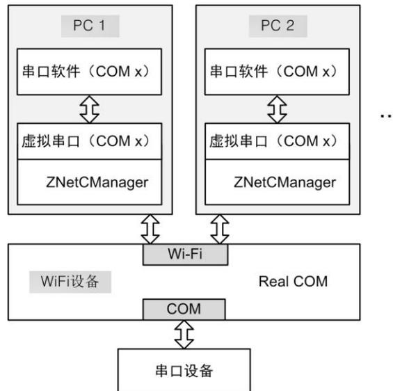
图 5.6 虚拟串口通信方式
