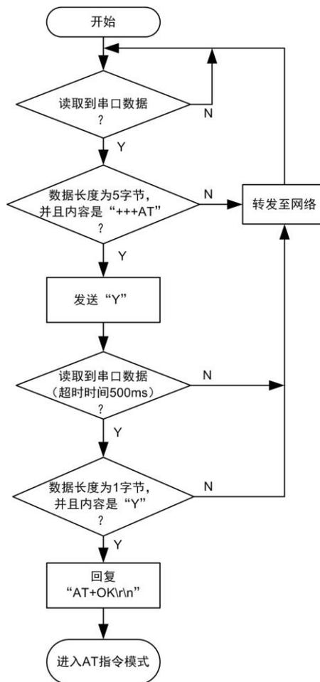
图 6.12 设备进入 AT 指令模式的处理流程
