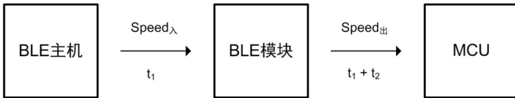
图 1.3 BLE 主机->MCU 透传框架
