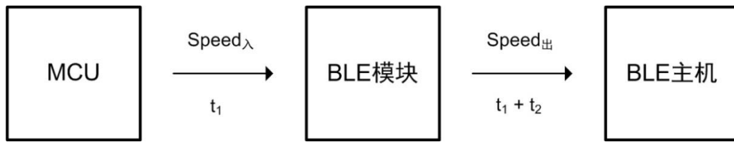
图 1.2 MCU->BLE 主机透传框架
